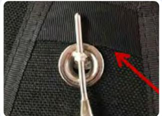
DEFEKTER LOOP UND PACKFEHLER PIN: PIN MUSS UNTER DAS BAND
